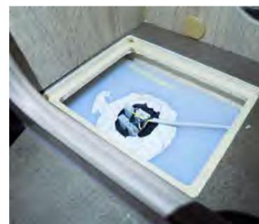
Ihr Reisemobil ist mit einem festen Frischwassertank mit einem Fassungsvermögen von 100 l ausgestattet. Er befindet sich unter der linken Bank, hinter dem Fahrersitz.
