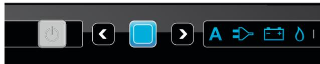
Drücken Sie nach dem Einschalten des Kühlschranks die Bestätigungstaste und halten Sie diese für 2 Sekunden gedrückt.
