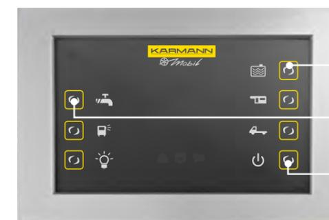
Kontrolleuchte Füllstand des Frischwassertanks
