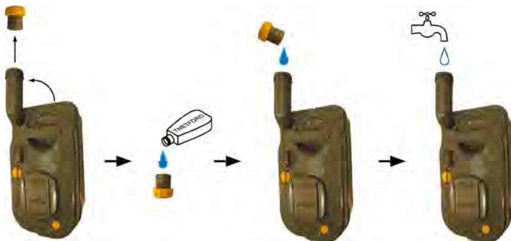
Hinweis: Bei sehr warmem Wetter oder bei längerer Lagerung muss möglicherweise mehr WC-Flüssigkeit verwendet werden. Um optimale Ergebnisse zu erzielen, verwenden Sie ausschließlich Flüssigkeiten für Thetford-WCs.
