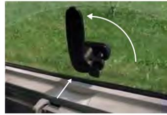
Um das Fenster zu öffnen, entriegeln Sie den Hebel durch Druck auf den Entriegelungsknopf und drehen Sie den Hebel nach links in die senkrechte Stellung.
