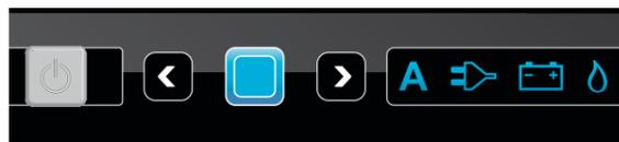
Drücken Sie nach dem Einschalten des Kühlschranks die Bestätigungstaste und halten Sie diese für 2 Sekunden gedrückt. Die Symbole für die Energiequellen leuchten auf und beginnen zu blinken.
