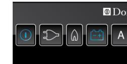
Der Kühlschrank wählt automatisch die beste verfügbare Energiequelle aus (in der Reihenfolge: Netzspannung, Batterie, Gas)
